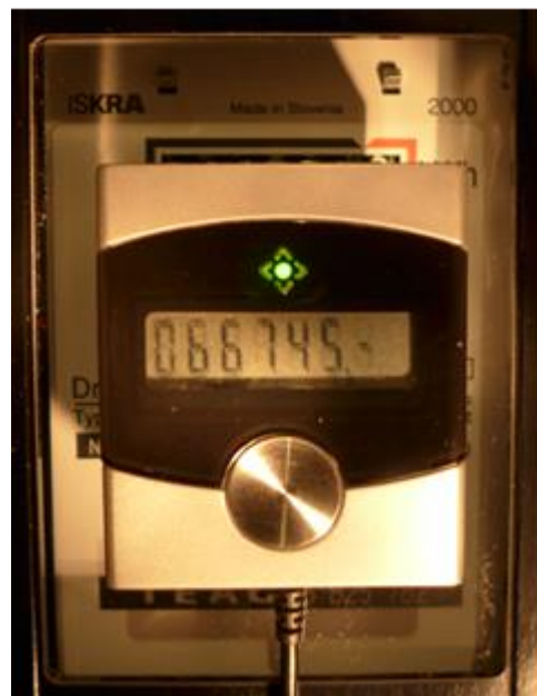
EnergyCam richtig montiert auf einen Ferrarisähler © Handwerkskammer für Ostthüringen
