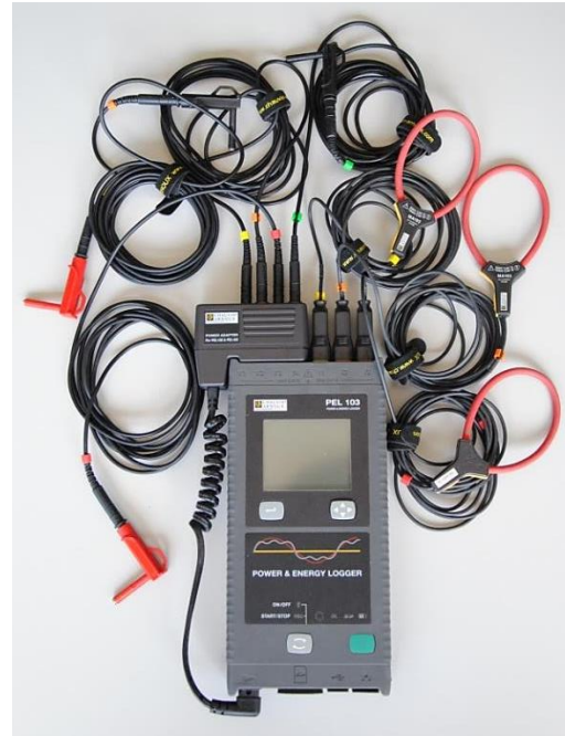
Leistungs- und Energierecorder © Handwerkskammer Hamburg
