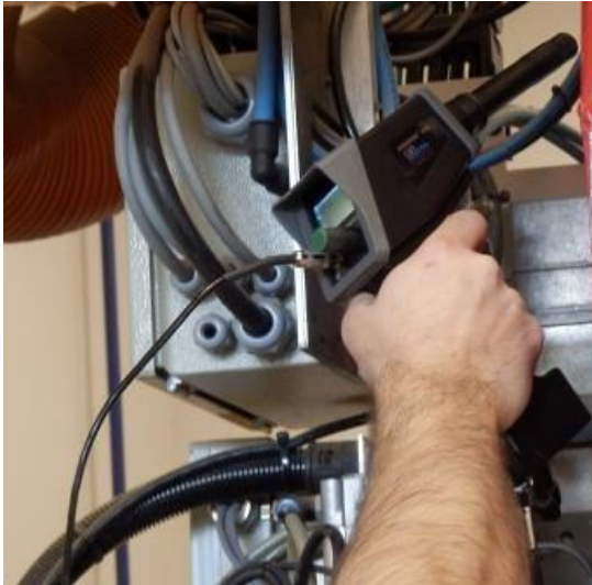
Ultraschallmessung an einer Druckluftleitung © Handwerkskammer Koblenz
